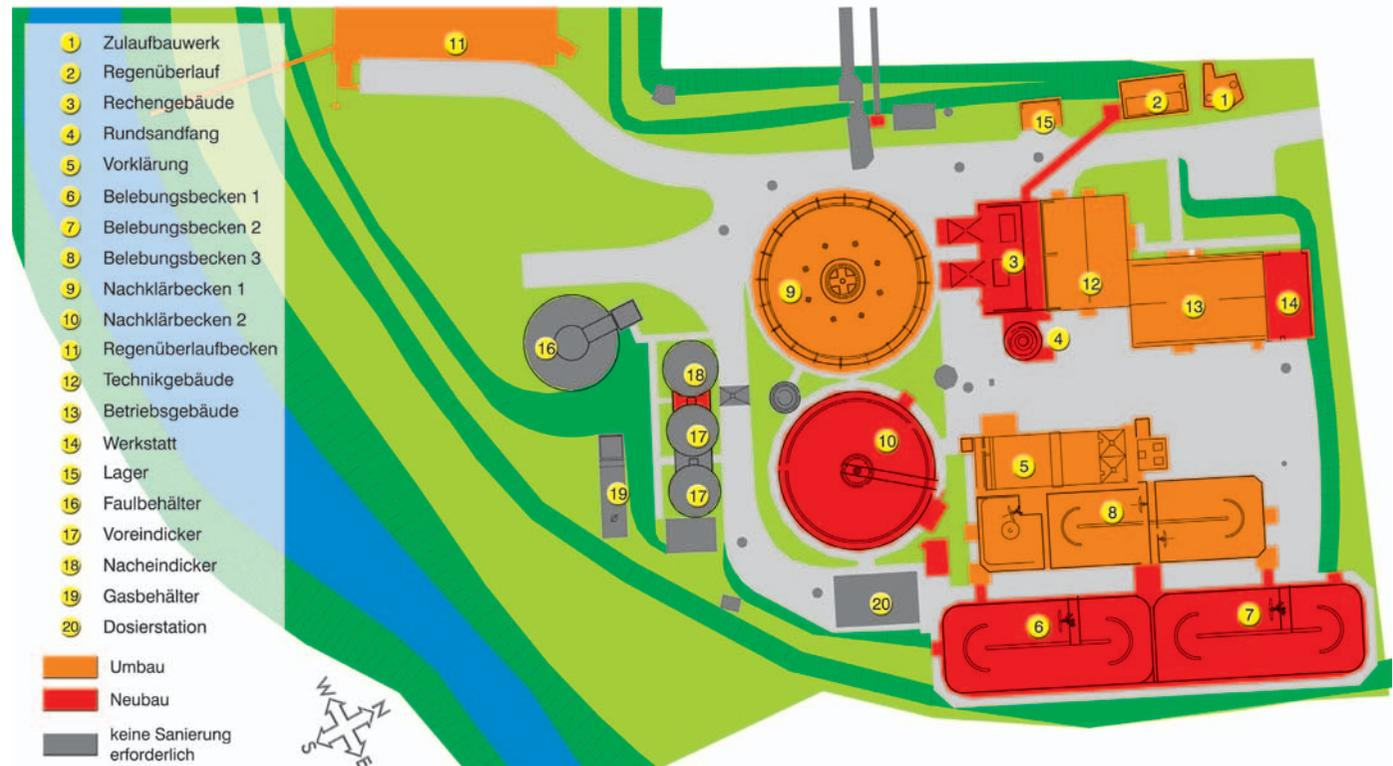
Zur Verbesserung der Stickstoffentfernung wurde die so genannte Belebungsstufe im Klärwerk Odenthal erweitert. Die vorhandene Belebungsstufe mit einem Beckenvolumen von rund 1.000 Kubikmetern wurde saniert. Durch den Bau von zwei neuen Belebungsbecken steht nun ein Belebungsbeckenvolumen von insgesamt 3.750 Kubikmetern zur Verfügung.
